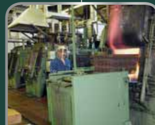
Закалка стальных деталей
