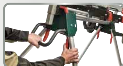
Складные рычажные механизмы быстрое и простое складывание/ раскладывания
